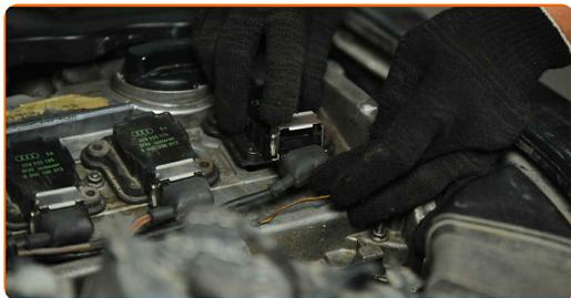
**16** Apriete las sujeciones de la bobina del encendido. Use Vaso HEX No. H5. Utilice una llave dinamométrica. Apriételo a un par de 12 Nm.
