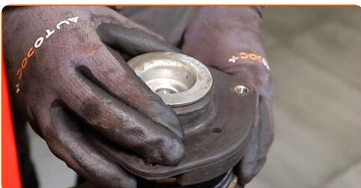
**48** Apriete la tuerca de la varilla de la pata amortiguadora. Vaso para tuerca de amortiguador de 21 mm. Use Vaso HEX No. H6. Utilice una llave dinamométrica. Apriételo a un par de 60 Nm.
