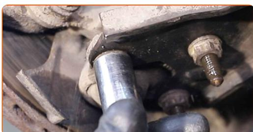
**68** Instale la barra del estabilizador de estabilidad transversal.
