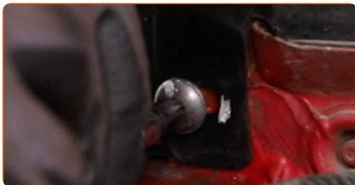
**91** Apriete las sujeciones del panel de plástico. Utilice Torx T30. Utilice una llave dinamométrica. Apriételo a un par de 8 Nm.
