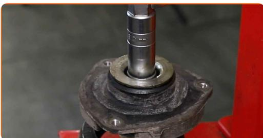
**40** Retire el soporte del puntal superior junto con el tope.
