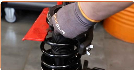
**47** Instale el soporte del puntal superior junto con el tope.
