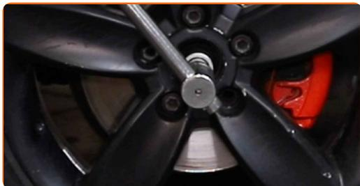
**11** Afloje los pernos de fijación de la rueda. Utilice una llave de impacto para llanta # 17.
