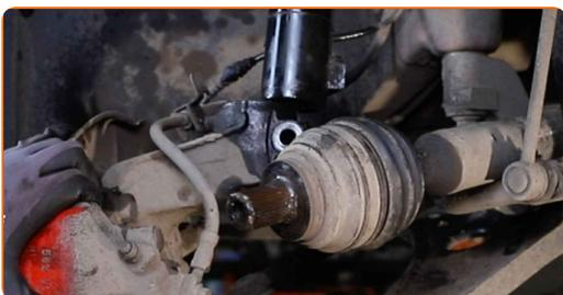
**34** Desatornille las sujeciones superiores del amortiguador.
