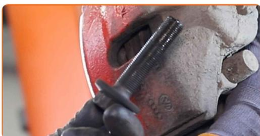
**30** Separe el eje de transmisión de la mangueta de dirección.
