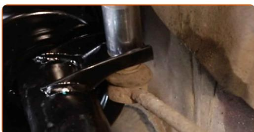
**70** Apriete las sujeciones inferiores del puntal de suspensión. Use un vaso de impacto del n.º 18. Utilice las puntas XZN #14. Utilice una llave dinamométrica. Apriételo a un par de 70 Nm.+90°
