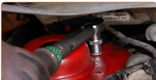
**88** Trate las sujeciones del soporte del amortiguador. Use grasa de cobre.
