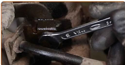
**21** Retire el soporte del latiguillo de freno.
