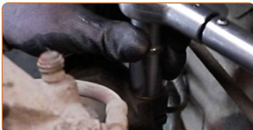
**71** Apriete la sujeción que conecta la bieleta de barra estabilizadora al amortiguador. Use un vaso de impacto del n.º 18. Utilice las puntas XZN #6. Utilice una llave dinamométrica. Apriételo a un par de 65 Nm.
