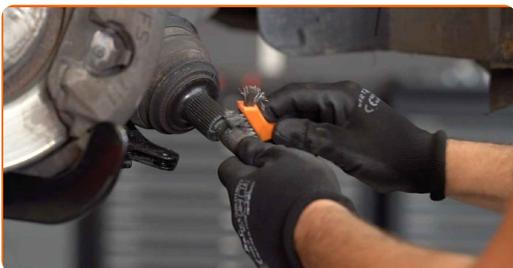
**42** Trate el asiento de montaje del puntal amortiguador en la mangueta de dirección. Use el aerosol WD-40.
