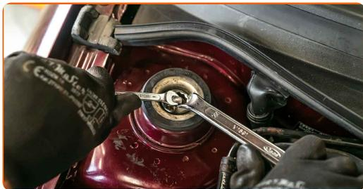
Sustitución: amortiguador telescópico - SKODA Octavia I Combi (1U5).
