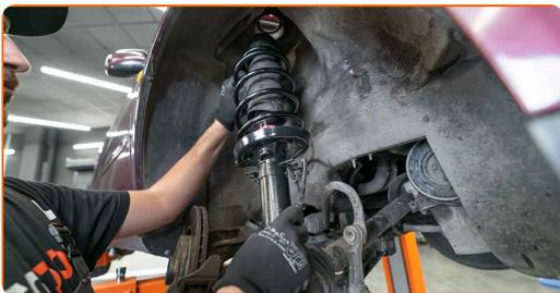
**40** Fije la tuerca de fijación superior en la pata amortiguadora. No lo apriete.
