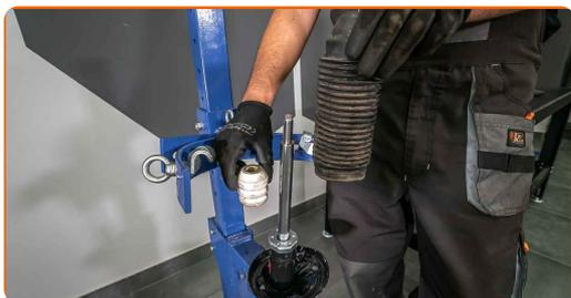
**30** Retire el amortiguador viejo del compresor de muelles hidráulico.
