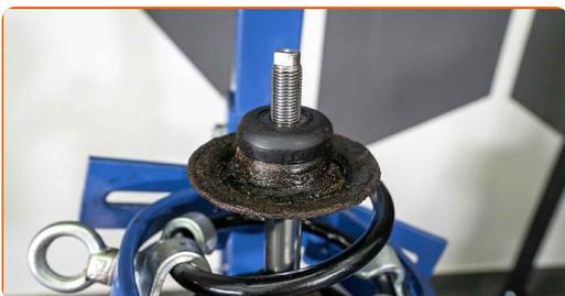
**35** Instale el soporte de montaje superior del puntal y el cojinete del soporte de montaje del puntal.
