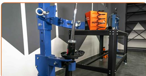
**32** Instale el guardapolvo y el tope en el amortiguador nuevo.
