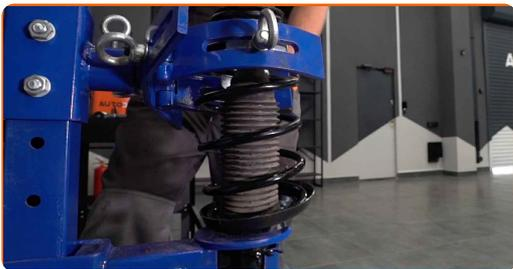
**38** Retire el puntal amortiguador que está montado.
