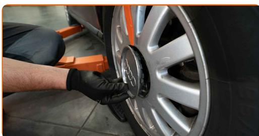
**5** Destornille la tuerca que fija el cubo. Utilice un vaso 1-3/16" de 12 puntos.
