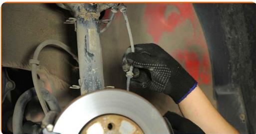
**10** Limpie las sujeciones que conectan el puntal amortiguador a la mangueta de dirección. Use un cepillo de alambre. Use el aerosol WD-40.
