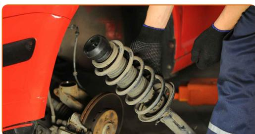
**31** Atornillen la fijación superior de la cazoleta de la pata amortiguadora. Use un vaso de impacto del n.º 21. No lo apriete.
