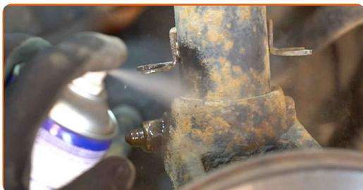
**8** Retire el perno de sujeción.
