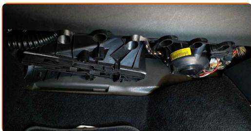
4 Retire la cubierta de la carcasa del filtro de habitáculo.
