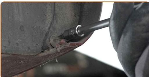
**5** Retire la cubierta del paso de rueda.
