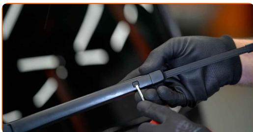
Sustitución: escobillas limpiaparabrisas - SKODA Octavia III Combi (5E5).
