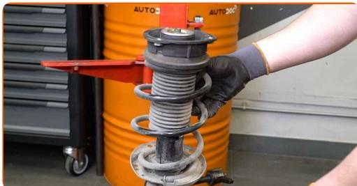
Sustitución: copelas del amortiguador - SKODA Octavia III Hatchback (5E3, NL3, NR3). Los profesionales recomiendan:
