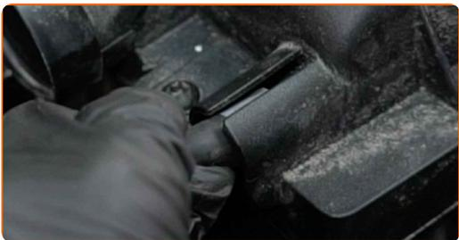
**15** Conecte la manguera del respiradero del cárter a la carcasa del filtro de aire.
