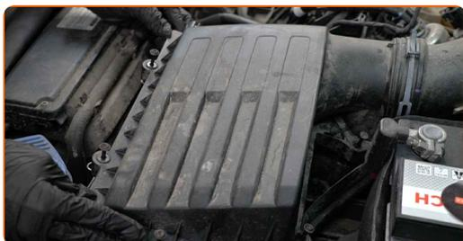
**13** Atornille los tornillos de sujeción de la cubierta del filtro de aire. Utilice Torx T25. Utilice una llave de trinquete.
