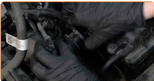
4 Desconecte la manguera de vacío de la carcasa del filtro de aire.
