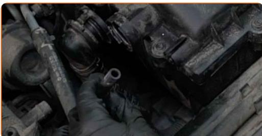
**5** Afloje los tornillos de sujeción de la cubierta del filtro de aire. Utilice Torx T25. Utilice una llave de trinquete.
