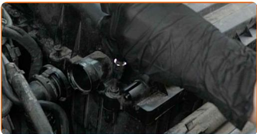
**14** Conecte la manguera de vacío a la carcasa del filtro de aire.
