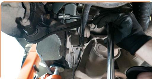
**11** Retire la pinza del freno junto con su soporte.
