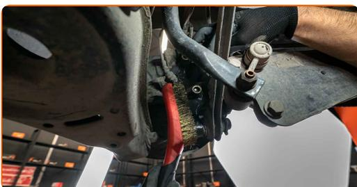
**10** Destornille la fijación de la pinza del cáliper de freno. Utilice las puntas XZN #14.
