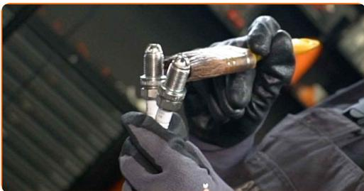
**8** Instale las nuevas bujías en sus asientos de montaje.
