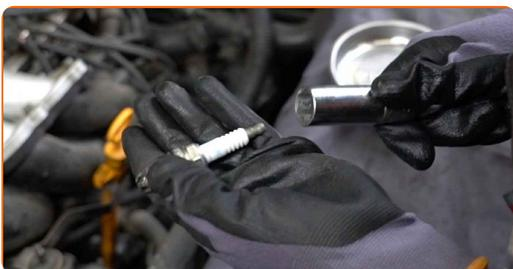
**7** Aplique una capa fina de un lubricante antigripado especial de alta temperatura a las roscas de las nuevas bujías.
