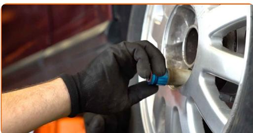
**33** Baje el automóvil y, manteniendo el orden cruzado, apriete los pernos de fijación de las ruedas. Utilice una llave dinamométrica. Apriételo a un par de 120 Nm.
