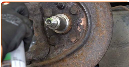
**17** Aplique grasa especial al asiento de montaje del ensamblaje del cojinete.
