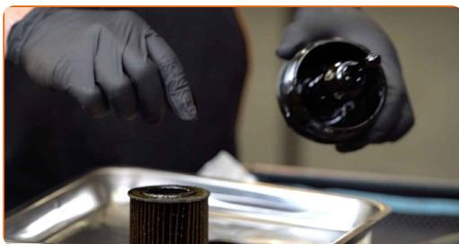
**18** Retire la junta tórica de la tapa del filtro de aceite. Utilice un destornillador plano.
