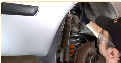
**13** Limpie la sujeción del vástago del amortiguador. Use un cepillo de alambre. Use el aerosol WD-40.
