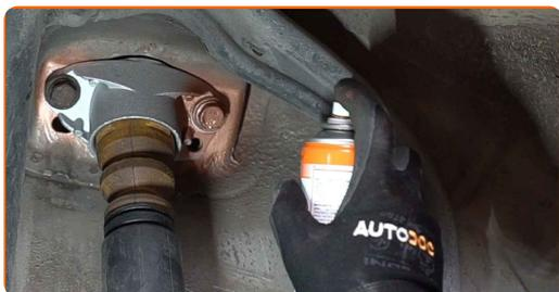
**27** Limpie los asientos de montaje del amortiguador. Use el aerosol WD-40.
