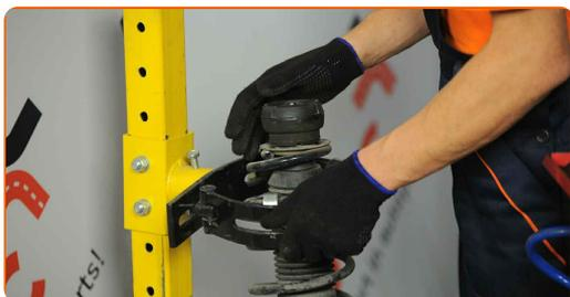
Sustitución: copelas del amortiguador - SKODA SLAVIA Sedán (PB2).
