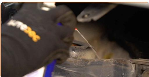
**19** Afloje la sujeción superior del soporte del amortiguador. Use un vaso de impacto del n.º 20.6. Utilice una llave de trinquete.
