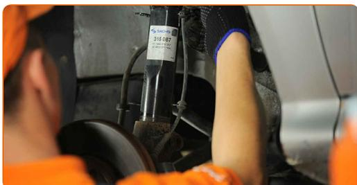
**14** Desconecte el muñón de dirección de la pata amortiguadora. Utilice un mazo de goma.
