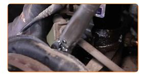
78 Conecte los cables del captador ABS.
