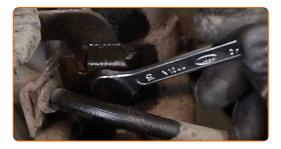
Retire el soporte del latiguillo de freno.
