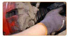
Instale y apriete el perno del eje de transmisión. Utilice un vaso 12 puntos nº 24. Utilice una llave de trinquete.
