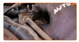
Ajuste la sujeción que conecta el soporte del latiguillo de freno al puntal de suspensión. Usa una llave mixta del n.º 10.
