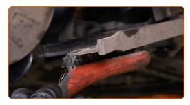
Limpie el asiento de montaje del puntal de suspensión en la mangueta de dirección. Limpie el asiento de montaje del eje CV. Use un cepillo de alambre. Use el aerosol WD-40.
