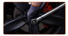
Apriete los pernos de la rueda usando un patrón entrecruzado. Utilice una llave de impacto para llanta # 17. Utilice una llave dinamométrica. Apriételo a un par de 120 Nm.
