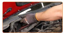
Enrosque las sujeciones del panel de plástico. Utilice Torx T30. Utilice una llave de trinquete.
