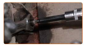
Retire el enlace estabilizador de estabilidad transversal.
