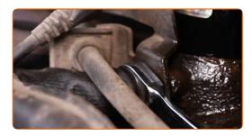
Atornille la fijación del soporte del latiguillo de freno a la pata amortiguadora. Use un vaso de impacto del n.º 10. Utilice una llave dinamométrica. Apriételo a un par de 12 Nm.
