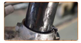
62 Instale el perno de sujeción.
