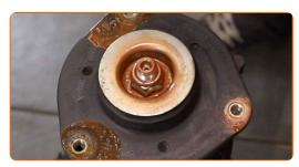
Retire el puntal amortiguador que está montado.
