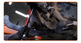
Suelte la sujeción inferior que conecta el puntal amortiguador a la mangueta de dirección. Utilice un vaso de impacto especial para extraer el amortiguador.
