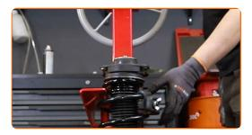
Trate la varilla del amortiguador. Use grasa de cobre.
