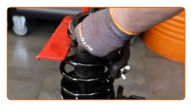
Instale el soporte del puntal superior junto con el tope.
