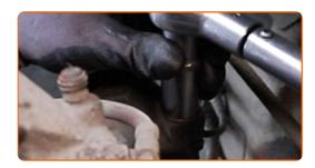
Apriete la sujeción que conecta la bieleta de barra estabilizadora al amortiguador. Use un vaso de impacto del n.º 18. Utilice las puntas XZN #6. Utilice una llave dinamométrica. Apriételo a un par de 65 Nm.
