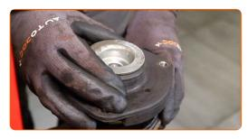
Apriete la tuerca de la varilla de la pata amortiguadora. Vaso para tuerca de amortiguador de 21 mm. Use Vaso HEX No. H6. Utilice una llave dinamométrica. Apriételo a un par de 60 Nm.
