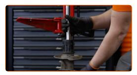
Instale el nuevo amortiguador en el compresor de muelles hidráulico.
