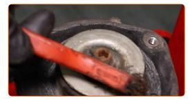
Destornille la tuerca de la varilla de la pata amortiguadora. Vaso para tuerca de amortiguador de 21 mm. Use Vaso HEX No. H7. Utilice una llave de trinquete.
