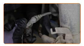
Limpie la sujeción que conecta el soporte del latiguillo de freno al puntal de suspensión. Use un cepillo de alambre. Use el aerosol WD-40.
