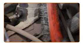
Desatornille la sujeción inferior que conecta el puntal amortiguador a la mangueta de dirección. Use un vaso de impacto del n.º 18. Utilice las puntas XZN #14. Utilice una llave de trinquete.
