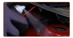
Afloje las sujeciones superiores del puntal de suspensión. Use un vaso de impacto del n.º 13. Utilice una llave de trinquete.
