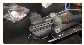
Destornille la fijación de la varilla del amortiguador. Usa una llave mixta del n.º 14.
