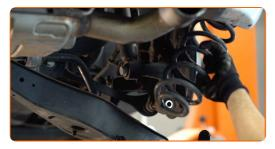
Destornille la fijación inferior del amortizador. Use un vaso de impacto del n.º 21. Utilice una llave giramachos.
