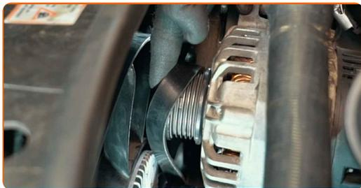
**15** Atornille la sujeción de la polea tensora de la correa del compresor de aire acondicionado. Use una llave mixta del n.º 17. Use Vaso HEX No. H7. Utilice una llave de trinquete.
