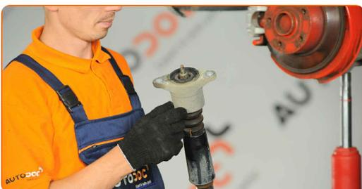
Sustitución: copelas del amortiguador - SKODA SUPERB (3U4). Consejo de AUTODOC:
