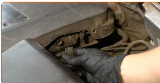
**4** Retire la cubierta del motor ensamblada con la carcasa del filtro de aire.
