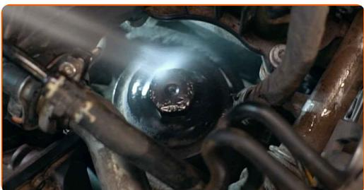
**7** Destornille la tapa del cuerpo del filtro junto con el elemento filtrante antiguo. Use un vaso de impacto del n.º 30. Utilice una llave de trinquete.
