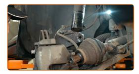
Desatornille las sujeciones superiores del amortiguador.
