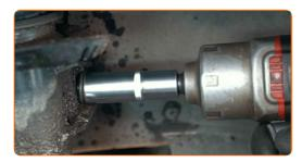
Retire el enlace estabilizador de estabilidad transversal.
