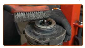
Destornille la tuerca de la varilla de la pata amortiguadora. Use un vaso de impacto del n.º 22. Use Vaso HEX No. H7. Utilice una llave de trinquete.
