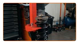
Retire el puntal amortiguador que está montado.
