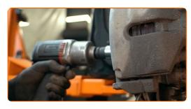
Retire el perno de sujeción.
