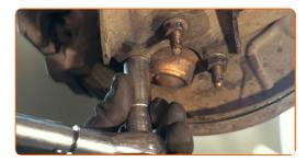
Atornille la fijación del soporte del latiguillo de freno a la pata amortiguadora. Usa una llave mixta del n.º 10.
