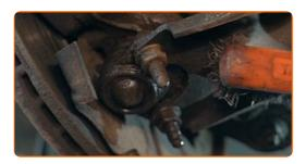
Desenrosque la fijación que conecta la rótula al brazo de control de la suspensión. Use un vaso de impacto del n.º 16. Utilice una llave de trinquete.
