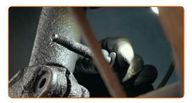
Suelte la sujeción inferior que conecta el puntal amortiguador a la mangueta de dirección. Utilice un cincel de metal plano. Utilice un martillo.
