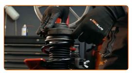
Apriete la tuerca de la varilla de la pata amortiguadora. Use un vaso de impacto del n.º 21. Use Vaso HEX No. H7. Utilice una llave dinamométrica. Apriételo a un par de 60 Nm.
