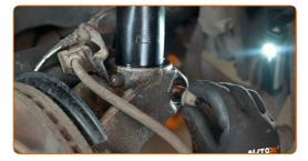
Atornille la sujeción que conecta el puntal de suspensión con la mangueta de dirección. Use un vaso de impacto del n.º 18. Utilice las puntas XZN #14. Utilice una llave de trinquete.
