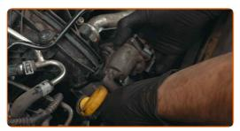
Apriete las sujeciones del cuerpo de mariposa al colector de admisión de aire. Utilice Torx T27. Utilice una llave dinamométrica. Apriételo a un par de 14 Nm.
