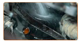
Desenrosque las sujeciones de la carcasa del termostato. Use un vaso de impacto del n.º 10. Utilice una llave de trinquete.
