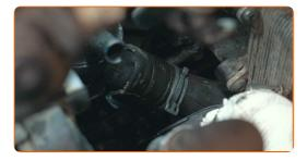
Una la abrazadera de la manguera superior de refrigerante. Utilice unos alicates de punta de aguja.
