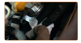
Desatornille las sujeciones que conectan la válvula de mariposa al colector de admisión. Utilice Torx T27. Utilice una llave de trinquete.
