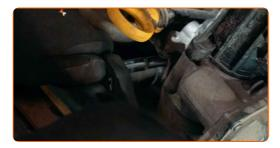
Desenrosque la sujeción del tubo de la varilla de nivel. Use un vaso de impacto del n.º 10. Utilice una llave de trinquete.
