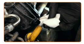
Instale la válvula de mariposa en el colector de admisión. Instale los pernos de sujeción.
