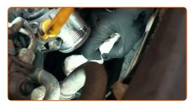
Limpie el asiento de montaje de la manguera de admisión de aire. Utilice un spray de limpieza multiuso.
