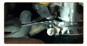
Asegure la sujeción del conducto de admisión de aire. Use un vaso de impacto del n.º 7. Utilice una llave de trinquete.
