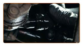
Asegure la abrazadera de la manguera de refrigerante. Utilice alicates para abrazaderas clic-R.
