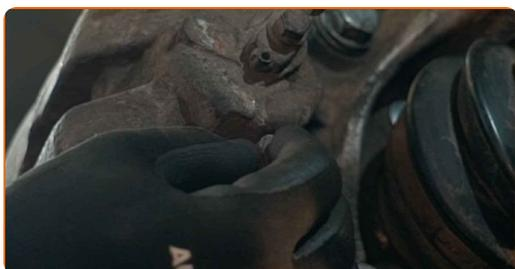
**33** Instale el resorte de fijación del cáliper de freno. Use una palanca.
