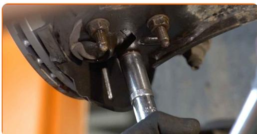
**66** Fije el soporte de fijación del latiguillo de freno. Fije el soporte del arnés de cables del ABS. Use una llave mixta del n.º 10.
