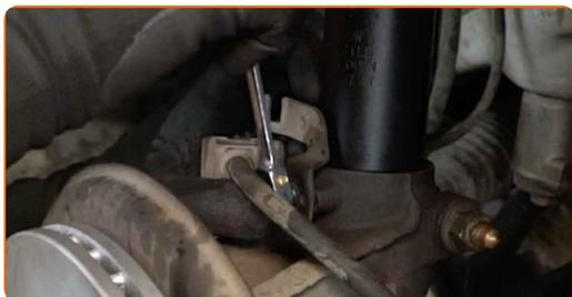
**67** Limpie los asientos de montaje de la bieleta de barra estabilizadora. Use un cepillo de alambre. Use el aerosol WD-40.
