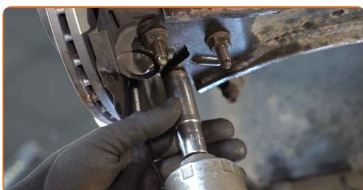
**63** Instale y apriete el perno del eje de transmisión. Use un vaso de impacto del n.º 27. Utilice una llave de trinquete.
