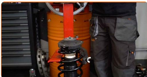
**49** Trate la varilla del amortiguador. Use grasa de cobre.
