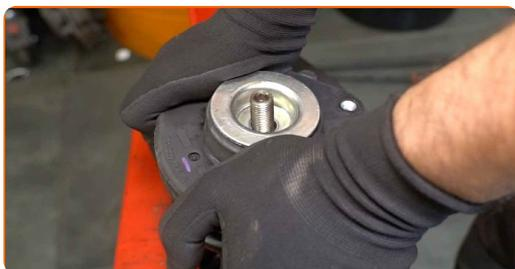
**47** Apriete la tuerca de la varilla de la pata amortiguadora. Use un vaso de impacto del n.º 21. Use Vaso HEX No. H6. Utilice una llave dinamométrica. Apriételo a un par de 60 Nm.
