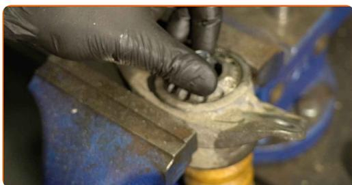
**29** Apriete la tuerca de la varilla del amortiguador. Utilice un vaso para amortiguador DDNº8. Use un vaso de impacto del n.º 16. Utilice una llave dinamométrica. Apriételo a un par de 25 Nm.
