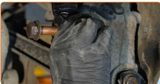
**41** Atornille la sujecion inferior del amortiguador. Use un vaso de impacto del n.º 21. Utilice una llave de trinquete.
