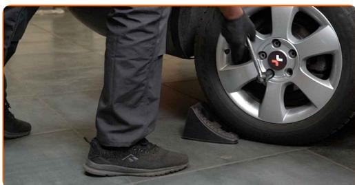
**3** Levante la parte trasera del automóvil y fije la posición sobre los pedestales.
