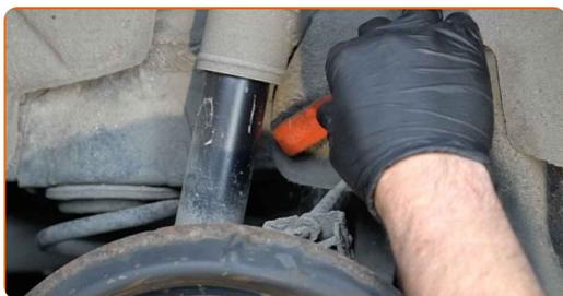
**7** Desatornille y retire las sujeciones de la cubierta del paso de rueda. Utilice Torx T25. Utilice una llave de trinquete.
