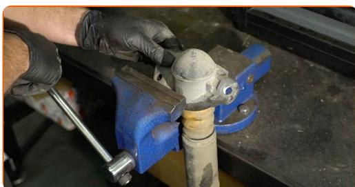
**24** Quite la tapa de protección del soporte del amortiguador. Use una palanca.
