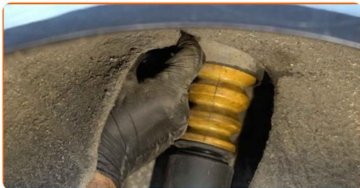
**36** Atornille la sujeción superior del amortiguador. Use un vaso de impacto del n.º 16. Utilice una llave de trinquete.
