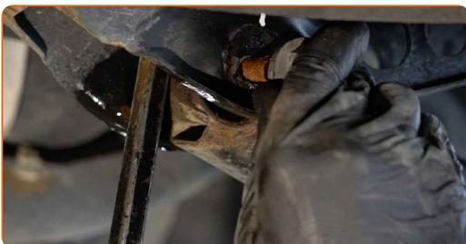
**47** Ajuste la posición del perno de alineación según la marca.
