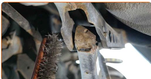
**10** Haga una marca en el perno de ajuste de la inclinación.
