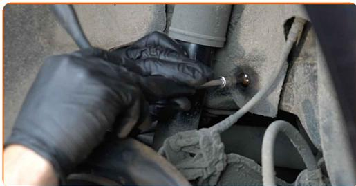
**8** Limpie las sujeciones del amortiguador. Use un cepillo de alambre. Use el aerosol WD-40.
