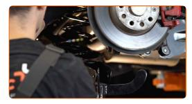
Apriete las sujeciones que conectan el brazo de control a la mangueta trasera. Usa una llave mixta del n.º 18. Use un vaso de impacto del n.º 18. Utilice una llave dinamométrica. Apriételo a un par de 90 Nm.+90°
