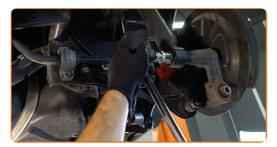
Destornille la fijación superior del amortiguador. Use un vaso de impacto del n.º 15. Utilice una llave de trinquete.
