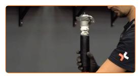
Fije la cazoleta del amortiguador. Usa una llave mixta del n.º 14. Use un vaso de impacto del n.º 14. Utilice una llave dinamométrica. Apriételo a un par de 25 Nm.
