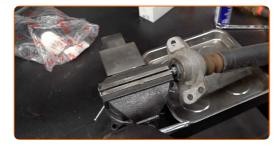
Destornille la fijación de la varilla del amortiguador. Usa una llave mixta del n.º 14.
