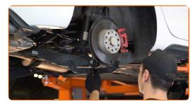
Desatornille la sujeción que conecta el brazo de control a la mangueta trasera. Usa una llave mixta del n.º 18. Use un vaso de impacto del n.º 18. Utilice una llave de trinquete.
