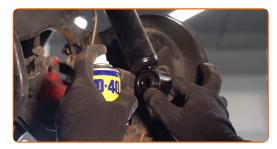
Apriete la fijación inferior del amortiguador. Use un vaso de impacto del n.º 21. Utilice una llave dinamométrica. Apriételo a un par de 180 Nm.
