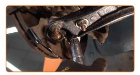
Apriete la fijación del soporte esférico. Use un vaso de impacto del n.º 16. Utilice una llave dinamométrica. Apriételo a un par de 60 Nm.
