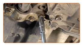
Desatornille la sujeción trasera que conecta el brazo de control a la carrocería del automóvil. Use un vaso de impacto del n.º 18. Utilice una llave giramachos.
