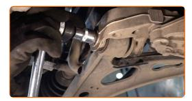
Retire los pernos de sujeción. Use un vaso de impacto del n.º 18. Use un vaso de impacto del n.º 16.
