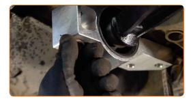
Atornille la sujeción trasera que conecta el brazo de control con la carrocería del coche. Use un vaso de impacto del n.º 18. Utilice una llave de trinquete.
