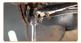
Apriete la sujeción delantera que conecta el brazo de control al subchasis. Use un vaso de impacto del n.º 18. Utilice una llave dinamométrica. Apriételo a un par de 70 Nm.+180°
