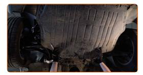
Apriete los sujetadores de la cubierta inferior del cárter de aceite. Utilice Torx T25.
