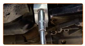
Atornille la sujeción trasera que conecta el brazo de control al subchasis. Use un vaso de impacto del n.º 16. Utilice una llave de trinquete.
