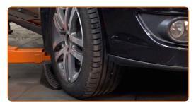
Afloje los pernos de fijación de la rueda. Utilice una llave de impacto para llanta # 17.
