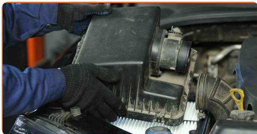
**13** Presione los clips de la cubierta del filtro de aire en su lugar.
