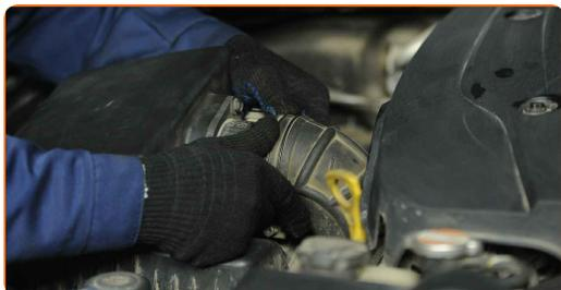
**15** Fije la abrazadera en el manguito de admisión de aire. Utilice un destornillador Phillips.
