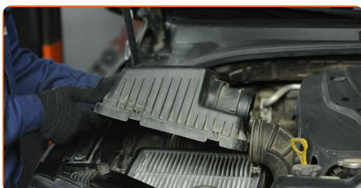
**9** Saque de la carcasa del filtro el elemento filtrante de recambio.
