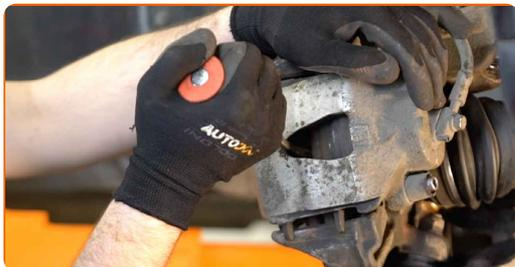
11 Retire el soporte de freno. Use una palanca.
