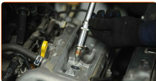
**18** Atornille las bujías nuevas y apriételas. Use el vaso de bujía # 16. Utilice una llave dinamométrica. Apriételo a un par de 25 Nm.
