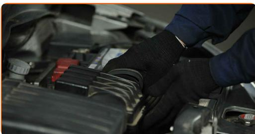
**27** Introduzca los pernos de fijación del cuerpo del filtro. Use un vaso de impacto del n.º 10. Utilice una llave de trinquete.
