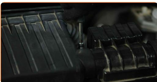
**28** Presione los clips de la cubierta del filtro de aire en su lugar.
