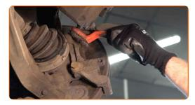
Destornille la fijación de la pinza del cáliper de freno. Use un vaso de impacto del n.º 17. Utilice una llave giramachos. Utilice una llave de trinquete.
