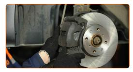
Usa una llave mixta del n.º 15. Use un vaso de impacto del n.º 13. Utilice una llave dinamométrica. Apriételo a un par de 35 Nm.
