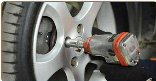
**22** Baje el automóvil y, manteniendo el orden cruzado, apriete los pernos de fijación de las ruedas. Utilice una llave de impacto para llanta # 21. Utilice una llave dinamométrica. Apriételo a un par de 85 Nm.
