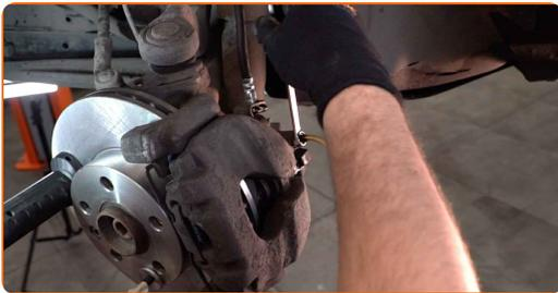
28 Desconecte la manguera del kit de purgado de frenos.
