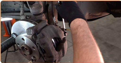
27 Apriete el tornillo de purgado de frenos. Usa una llave mixta del n.º 11.
