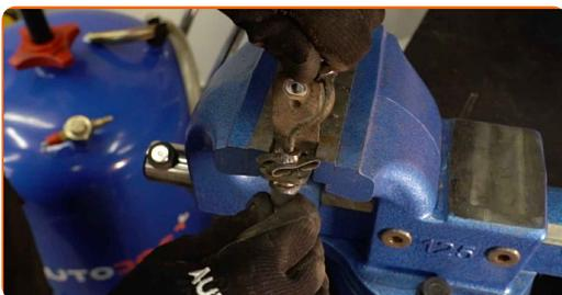
**16** Afloje el tornillo de banco y retire el soporte de montaje del latiguillo de freno.
