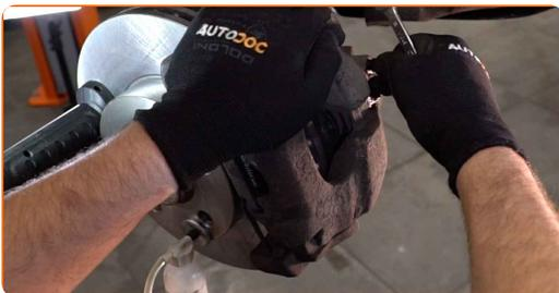
29 Limpie la suciedad del perno del latiguillo de freno. Use un limpiador de frenos.
