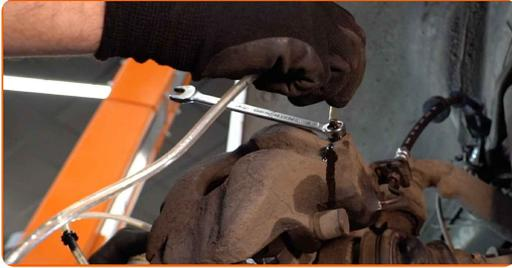
26 Presione varias veces el pedal de freno para retirar aire del sistema.
