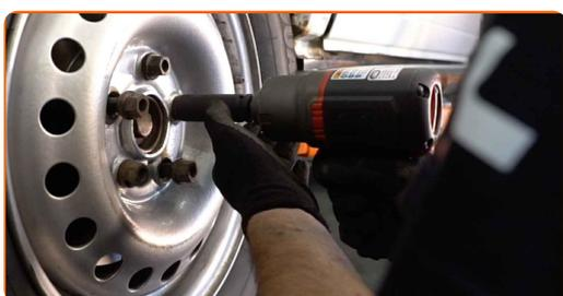
**35** Baje el automóvil y, manteniendo el orden cruzado, apriete los pernos de fijación de las ruedas. Utilice una llave dinamométrica. Apriételo a un par de 170 Nm.
