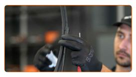
Presione el clip de fijación. Retire la escobilla del brazo del limpiaparabrisas.
