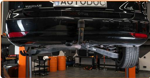
21 Instale el soporte de montaje del amortiguador usando el orificio central como guía.
