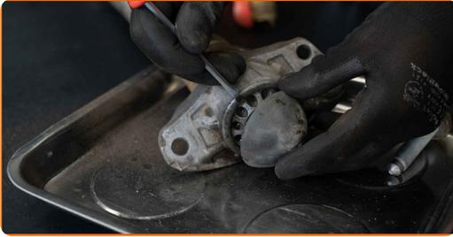
13 Destornille la fijación de la varilla del amortiguador. Usa una llave mixta del n.º 16. Use una llave ajustable.
