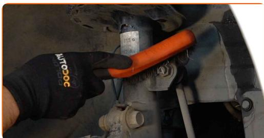
**11** Desconecte los cables eléctricos y el latiguillo de freno del soporte en la pata amortiguadora. Use un vaso de impacto del n.º 14. Utilice una llave de trinquete.
