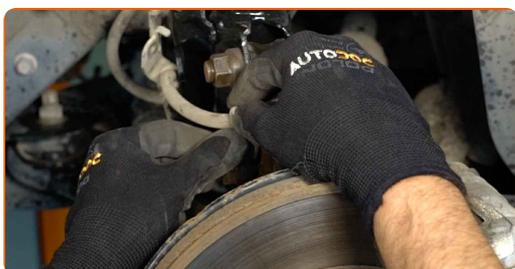
**46** Instale la barra del estabilizador de estabilidad transversal.
