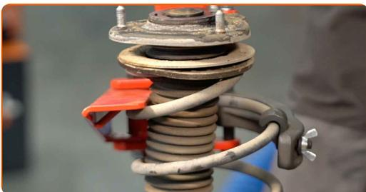
**23** Quite la tapa del soporte del amortiguador. Use una palanca.
