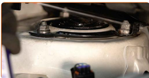
**4** Afloje la sujeción superior del soporte del amortiguador. Usa una llave mixta del n.º 14.
