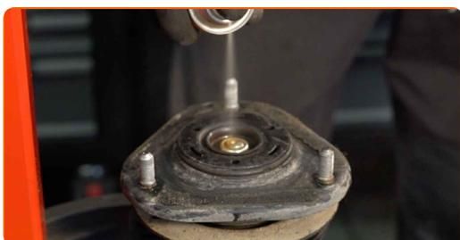
**34** Instale la tapa del soporte del amortiguador.
