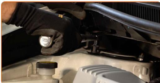
**55** Trate las sujeciones del soporte del amortiguador. Use grasa de cobre.
