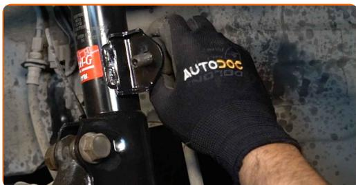
**47** Apriete la sujeción que conecta la bieleta de barra estabilizadora al amortiguador. Use un vaso de impacto del n.º 17. Utilice una llave dinamo-métrica. Apriételo a un par de 74 Nm.
