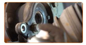
Destornille la fijación del cojinete del cubo. Use un vaso de impacto del n.º 17. Utilice una llave giramachos.
