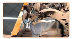
Limpie las sujeciones del rodamiento del cubo de rueda. Use un cepillo de alambre. Use el aerosol WD-40.
