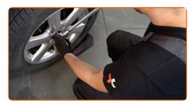
Golpee con el martillo la sujeción del eje de transmisión. Utilice un cincel de metal plano. Utilice un martillo.
