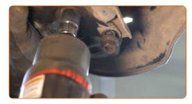
Apriete la fijación del soporte esférico. Use un vaso de impacto del n.º 17. Utilice una llave dinamométrica. Apriételo a un par de 92 Nm.
