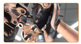
Apriete la sujeción del rodamiento de cubo de rueda. Use un vaso de impacto del n.º 17. Utilice una llave dinamométrica. Apriételo a un par de 96 Nm.
