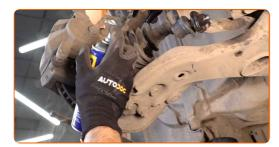
Destornille la fijación de la pinza del cáliper de freno. Use un vaso de impacto del n.º 17. Utilice una llave giramachos.
