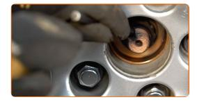
Apriete los pernos de la rueda usando un patrón entrecruzado. Utilice una llave dinamométrica. Apriételo a un par de 103 Nm.
