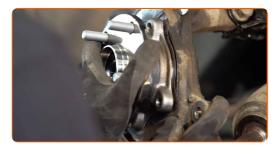
Atornille la fijación del cojinete del cubo. Use un vaso de impacto del n.º 17. Utilice una llave de trinquete.
