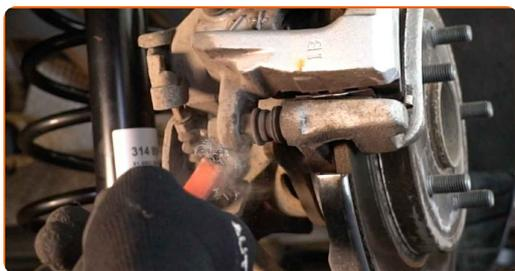
**8** Separe el cable del freno de estacionamiento del soporte de la pinza del freno. Use alicates de bomba de agua.
