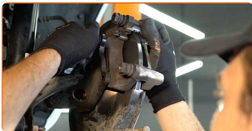
**22** Apriete la fijación de la pinza del cáliper de freno. Use un vaso de impacto del n.º 14. Utilice una llave dinamométrica. Apriételo a un par de 57 Nm.
