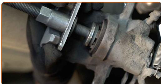
**26** Establezcan el soporte de freno y lo fijen. Usa una llave mixta del n.º 17. Use un vaso de impacto del n.º 14. Utilice una llave dinamométrica. Apriételo a un par de 35 Nm.
