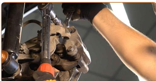
**27** Instale el cable del freno de estacionamiento en el soporte de la pinza del freno.
