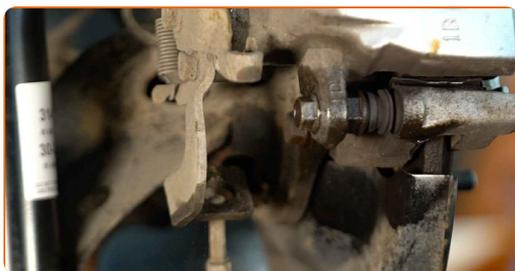
**9** Destornille la fijación del cáliper de freno. Usa una llave mixta del n.º 14. Usa una llave mixta del n.º 17.
