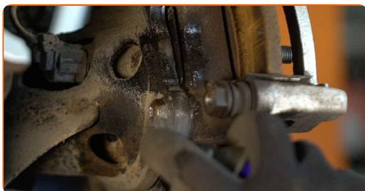
**14** Destornille la fijación de la pinza del cáliper de freno. Use un vaso de impacto del n.º 14. Utilice una llave giramachos. Utilice una llave de trinquete.
