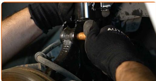
**44** Atornille la sujeción que conecta el puntal de suspensión con la mangueta de dirección. Usa una llave mixta del n.º 22. Use un vaso de impacto del n.º 22.
