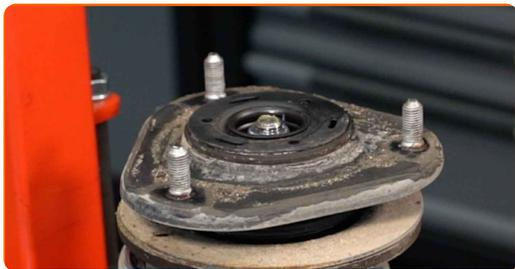
**24** Trate la varilla del amortiguador. Use un cepillo de alambre. Use el aerosol WD-40.
