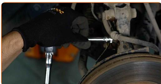
**12** Limpie las sujeciones que conectan el puntal amortiguador a la mangueta de dirección. Use un cepillo de alambre. Use el aerosol WD-40.
