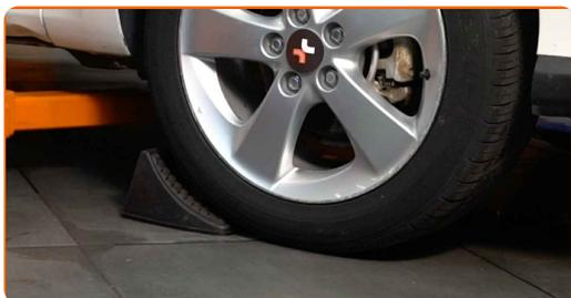
**6** Afloje los pernos de fijación de la rueda. Utilice una llave de impacto para llanta # 21.
