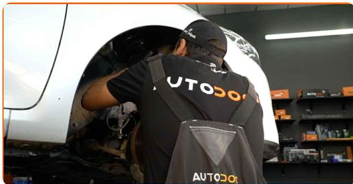
**40** Atornillen la fijación superior de la cazoleta de la pata amortiguadora. No lo apriete.
