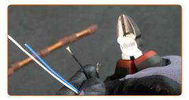
Coloque el tubo termorretráctil en el cableado de la sonda lambda.
