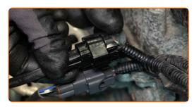
Sujete el cableado de la sonda lambda con la abrazadera.
