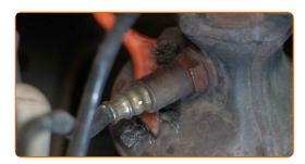
Desenrosque la sujeción del sensor de oxígeno. Utilice una llave de tuerca abocinada #22. Utilice una llave de trinquete.
