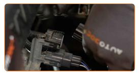
Desabroche la abrazadera para liberar el arnés de cableado de la sonda lambda. Utilice un destornillador plano.
