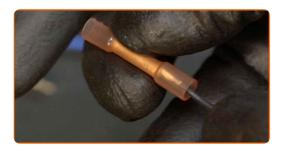
Crimpe los manguitos de soldadura. Use alicates para crimpar.
