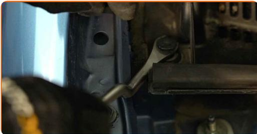
**6** Trate las sujeciones de la conexión del varillaje del limpiaparabrisas. Use el aerosol WD-40.
