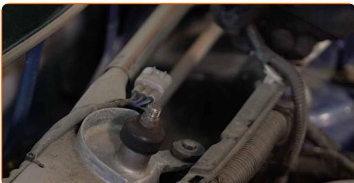
**8** Desenrosque las sujeciones del panel del varillaje del limpiaparabrisas. Use un vaso de impacto del n.º 10. Utilice una llave de trinquete.
