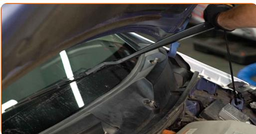
**5** Retire las cubiertas del brazo del limpiaparabrisas. Utilice una herramienta de extracción de clips.
