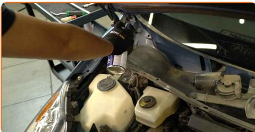
**7** Desconecte el conector del limpiaparabrisas.
