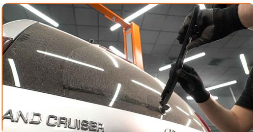
**3** Presione el clip de fijación. Utilice un destornillador plano.
