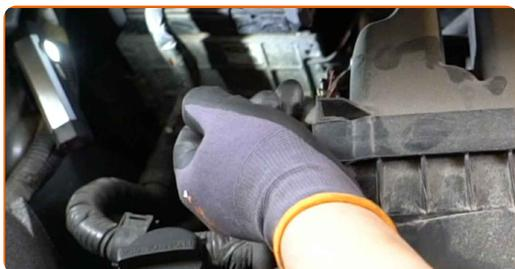
**4** Desconecte el tubo de entrada de aire de la carcasa del filtro de aire.
