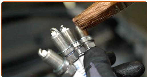
**21** Instale las nuevas bujías en sus asientos de montaje.
