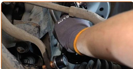
**13** Atornille las sujeciones de la barra estabilizadora. Use un vaso de impacto del n.º 14. Utilice una llave de trinquete.
