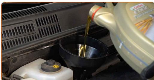
Sustitución: aceite de motor y filtro - TOYOTA Corolla Hatchback (\_E7\_).
