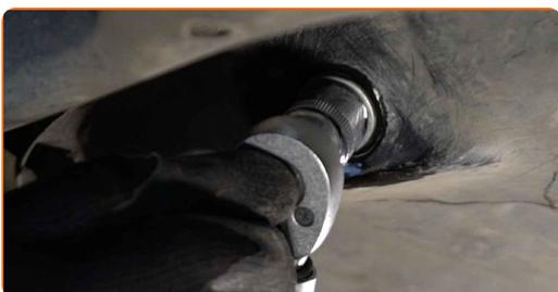
**17** Limpie el área del orificio de drenaje de la bandeja de aceite. Utilice un spray de limpieza multiuso.
