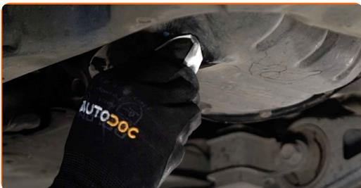
**16** Atornille en el nuevo tapón de drenaje y apriételo. Use un vaso de impacto del n.º 14. Utilice una llave dinamométrica. Apriételo a un par de 27 Nm.
