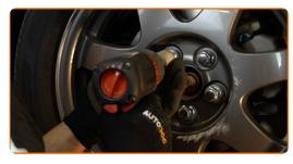
Baje el automóvil y, manteniendo el orden cruzado, apriete los pernos de fijación de las ruedas. Utilice una llave dinamométrica. Apriételo a un par de 103 Nm.
