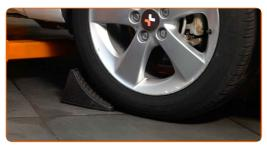
Afloje los pernos de fijación de la rueda. Utilice una llave de impacto para llanta # 21.
