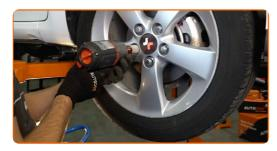
Baje el automóvil y, manteniendo el orden cruzado, apriete los pernos de fijación de las ruedas. Utilice una llave de impacto para llanta # 21. Utilice una llave dinamométrica. Apriételo a un par de 103 Nm.
