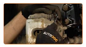
9 Separe las pastillas de freno. Use una palanca.
