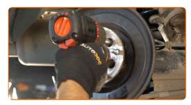
Quite por completo el cubo junto con el cojinete puesto que presentan un conjunto no desmontable. Utilice el extractor de cubos de rueda con martillo deslizante.
