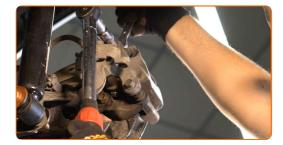
Instale el cable del freno de estacionamiento en el soporte de la pinza del freno.
