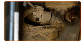
Desconecte el cableado del captador ABS.
