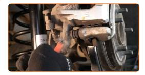
Separe el cable del freno de estacionamiento del soporte de la pinza del freno. Use alicates de bomba de agua.
