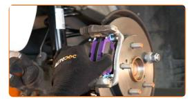
Establezcan el soporte de freno y lo fijen. Usa una llave mixta del n.º 17. Use un vaso de impacto del n.º 14. Utilice una llave dinamométrica. Apriételo a un par de 35 Nm.
