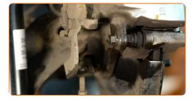
Destornille la fijación del cáliper de freno. Usa una llave mixta del n.º 14. Usa una llave mixta del n.º 17.
