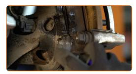
Destornille la fijación de la pinza del cáliper de freno. Use un vaso de impacto del n.º 14. Utilice una llave giramachos. Utilice una llave de trinquete.
