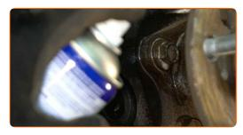
Limpie el conector del sensor ABS. Utilice un spray de limpieza multiuso.
