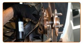
Conecte el conector del sensor ABS.
